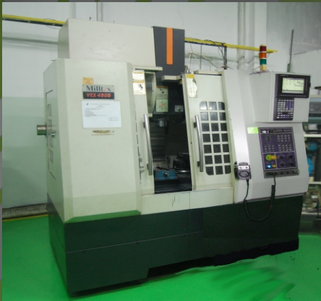
Mill CNC M/C Milltex, VBE-450B # 700 x 400 x 400
